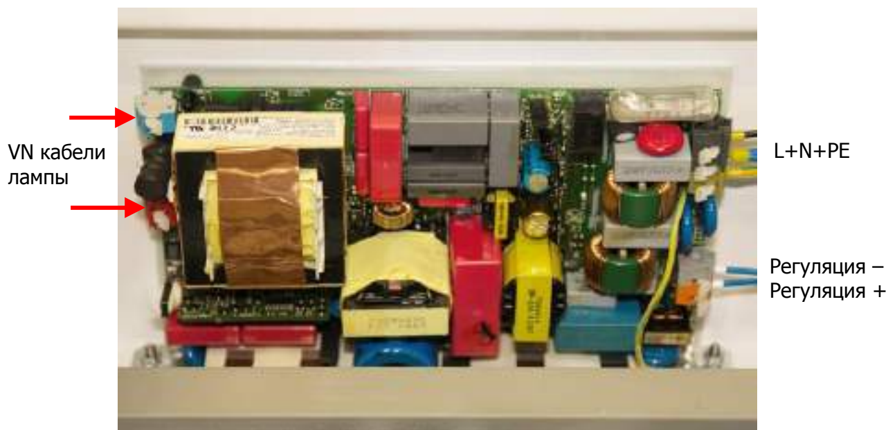
Рис. 14 Подключение проводов в электронном балласте
