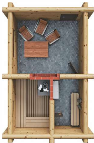
Рис. 5 Пример установки печи в кирпичном кожухе с функцией обогрева комнаты отдыха и моечного отделения
